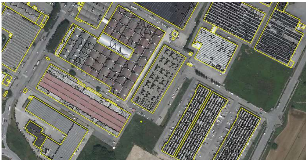
Figura 15 - Stessa immagine precedente con il risultato della classificazione ad oggetti. Si noti come il capannone che presentava due colorazioni è stato individuato dal classificatore.
